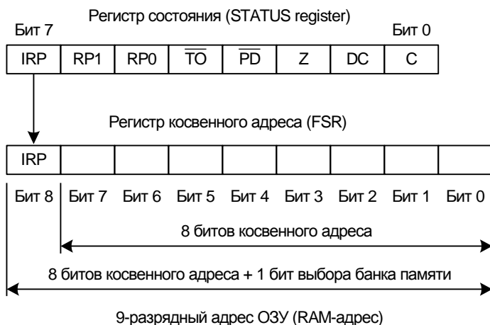
Рис. 1.7. Структура RAM-адреса для косвенной адресации
