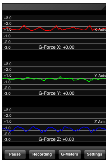
Рис. 1.14. Тестирование акселерометра при ходьбе с помощью AccelGraph
