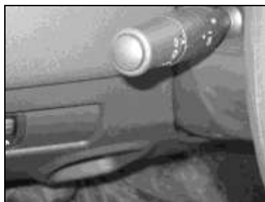
Рис. 1.6. Переключатель указателей поворота, габаритных огней и света фар
