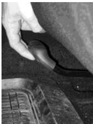
Рис. 1.8. Рычаг регулировки водительского сиденья по горизонтали
