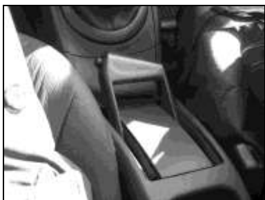
Рис. 1.5. Рычаг стояночного тормоза на автомобиле «Рено»
