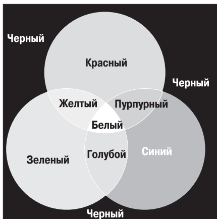
Рис. В8. Формирование цвета на экране монитора (модель RGB)
