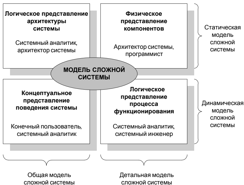
Рис. 1.1. Общая архитектура моделей и представлений сложной системы
