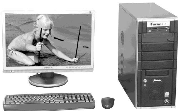
Рис. 1.2. Стандартный комплект для рабочего места: персональный компьютер PC с жидкокристаллическим монитором со встроенными звуковыми колонками, клавиатура и мышь
